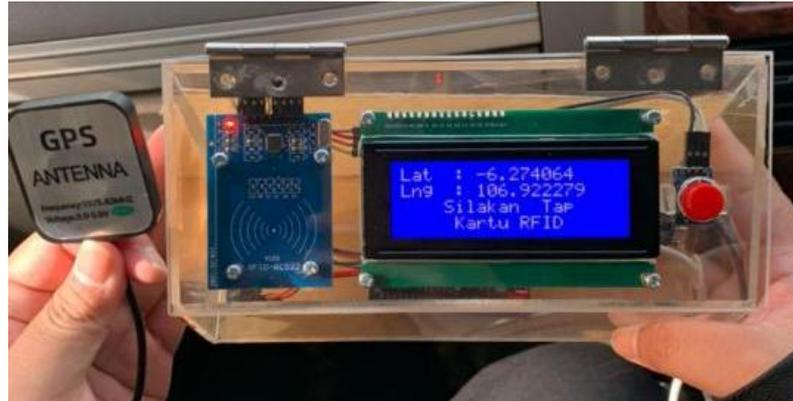
Gambar 3. Hasil Skema rangkaian Keseluruhan perangkat Keras
