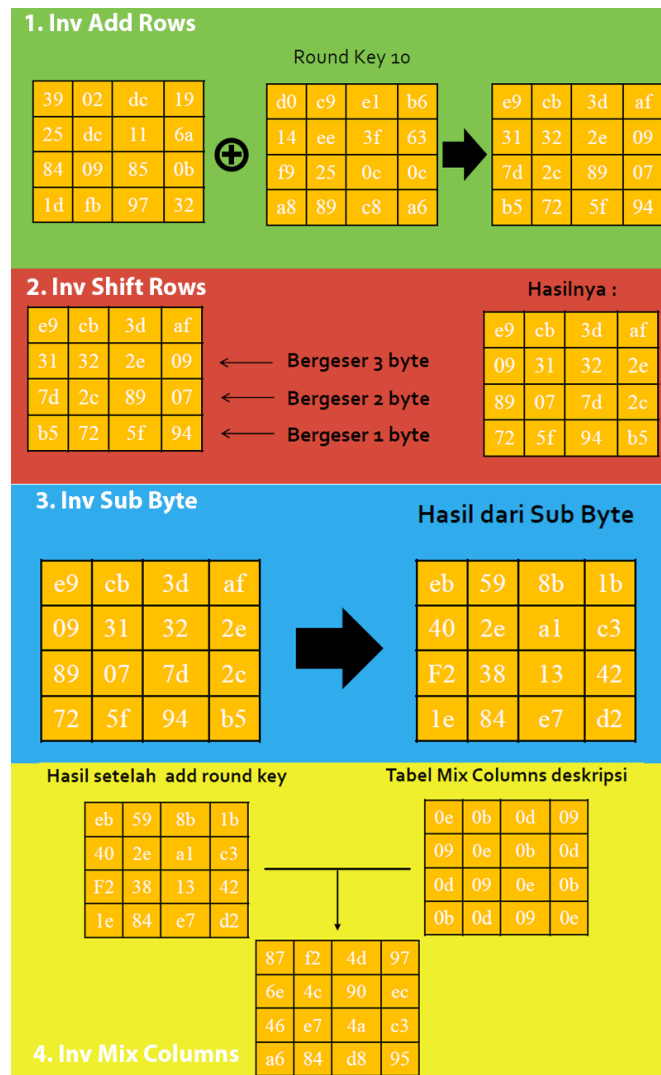
Gambar 8. Proses Dekripsi Algoritma AES
