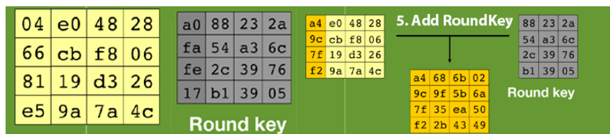
Gambar 6. Ilustrasi Proses Enkripsi Algoritma AES – Add RoundKey
