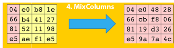
Gambar 5. Ilustrasi Proses Enkripsi Algoritma AES – MixColumns
